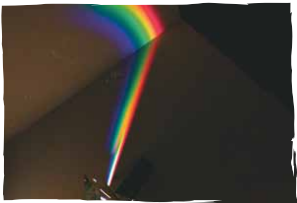
El prisma es un instrumento que permite realizar la descomposición de la luz.
